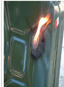
Orificio con gas incendiado
